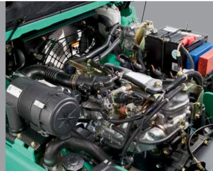
**Fresco y silencioso:** El ventilado y el sistema de radiador el montacargas están equipados con un sistema de enfriamiento de flujo transversal horizontal para ayudar a mantener el motor fresco y funcionando a su máximo desempeño. El diseño corrugado proporciona intercambio de calor óptimo, al mismo tiempo que el núcleo de aluminio ayuda a evitar la corrosión. El ventilador de impulsión directa también reduce el ruido y el mantenimiento necesario, beneficiando a sus operadores y a su negocio.
