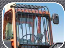
Rejilla de protección
